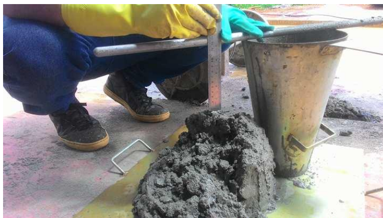
Figura 4.1: Execução do slump test
