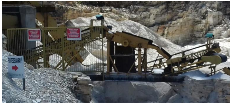
Figura 2 – Britador tipo mandíbula usado na britagem do rejeito
