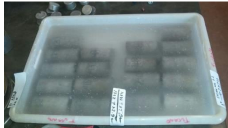
273 Figura 4 - Cp's cilíndricos para ensaios de compressão
