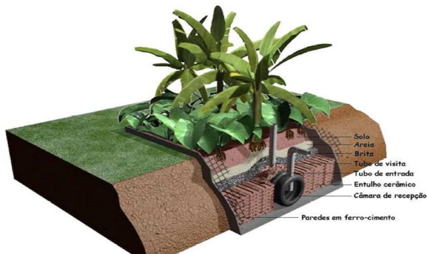
443 444 Figura 5 – Tanque de evapotranspiração. Fonte: (GALBIATI, 2009)
