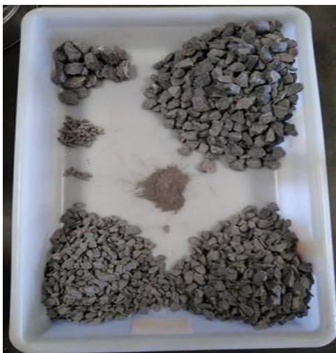
Figura 12 – Ensaio de granulometria da brita 1.
