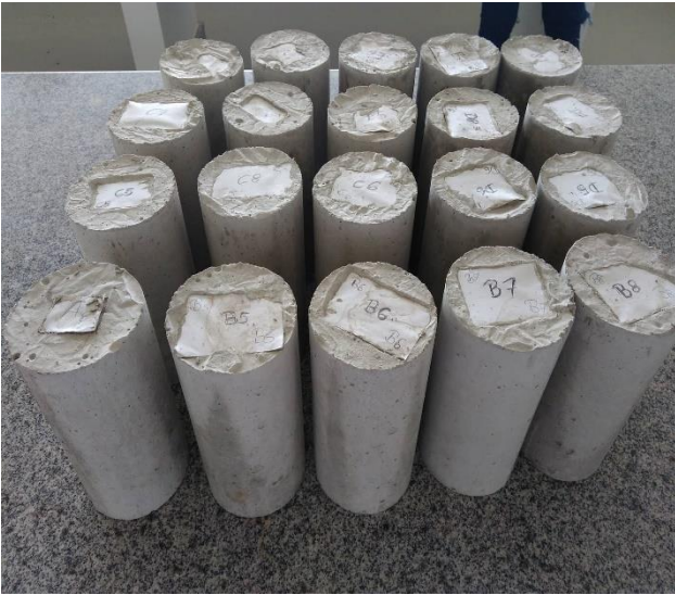
623 Figura 16 – Corpos de prova submetidos a cura ao ar.
