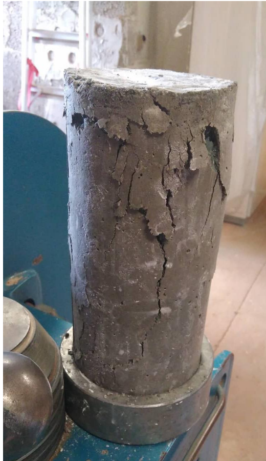
Figura 18 – Corpo de prova após o rompimento.
