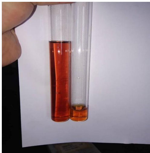
Figura 11 – Ensaio de Impurezas orgânicas.
