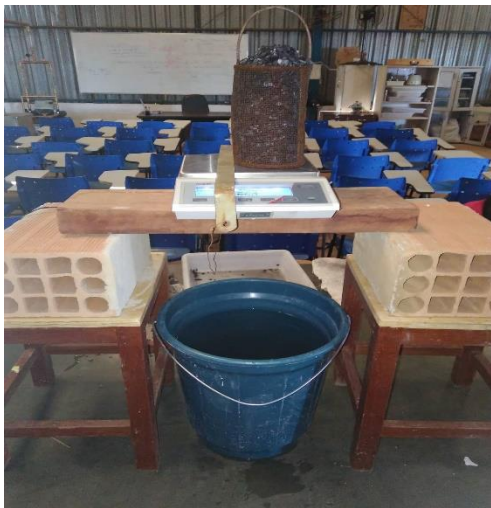
Figura 10 – Ensaio de massa específica da brita 1.
