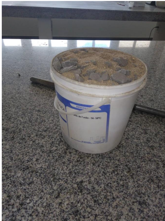
Figura 15 – Ensaio de massa unitária compactada das misturas.
