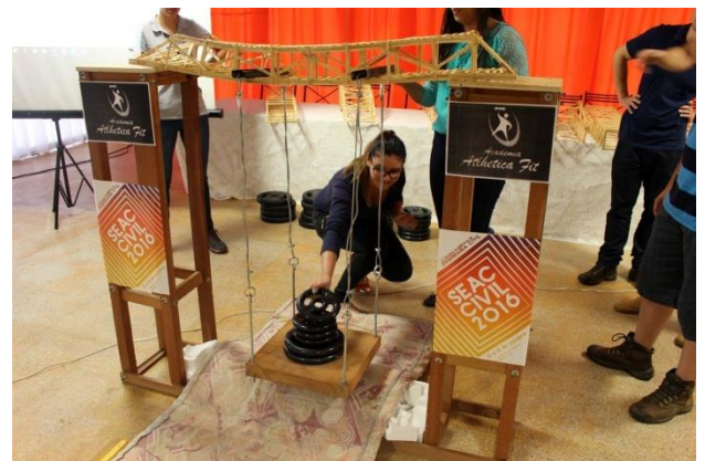
Figura 2: Ponte sendo submetida à tensão
