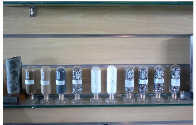
Figura 2: Amostras dos diversos processos pelo qual nióbio é submetido e seus subprodutos.
